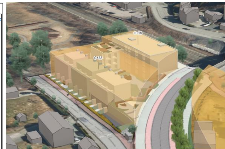
Utsnitt 3d-modell Stabekk sentrum, illustrasjon: Bærum kommune; delvis gjennomskjete, oransje volumer illustrerer rammene i områdeplanen for Stabekk sentrum (byggegrenser og høyder), viste kotehøyder er fra områdeplanen
