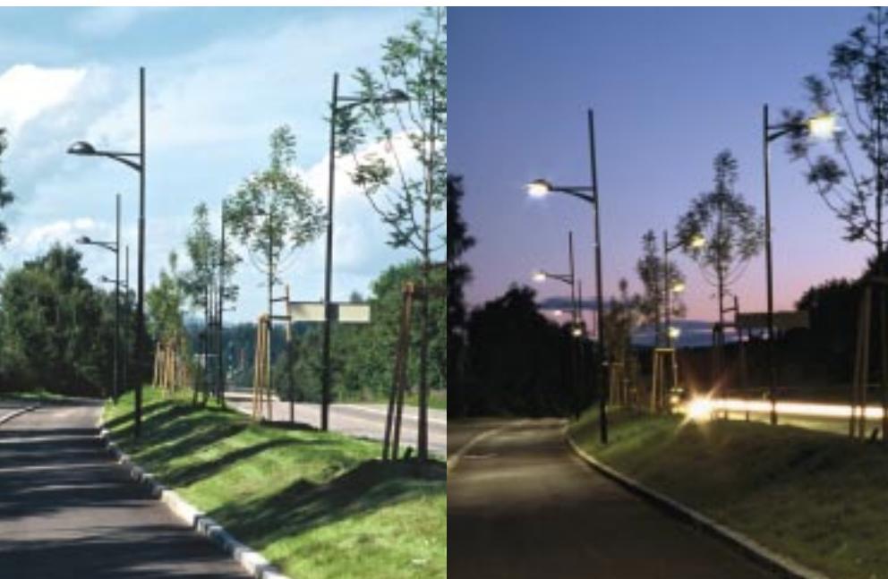
Bildet viser belysning av gangvei/sykkelvei i tilknytning til en samlevei. Bilde fra Oslo.
