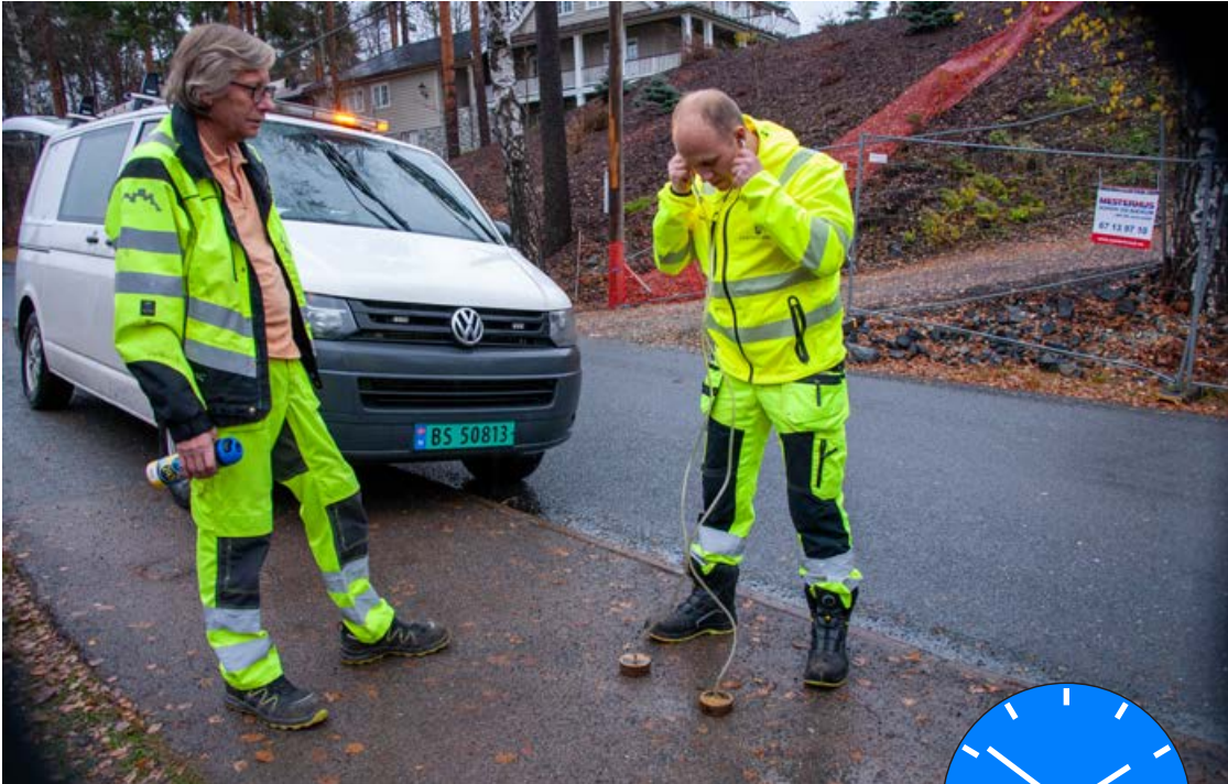
LYTTER: Bjørn Oppegaard (til venstre) og Tom-Rune Kaurin rykker ut for å lete og lytte etter lekkasjer. ALLE FOTO: GEIR HAUGEN
