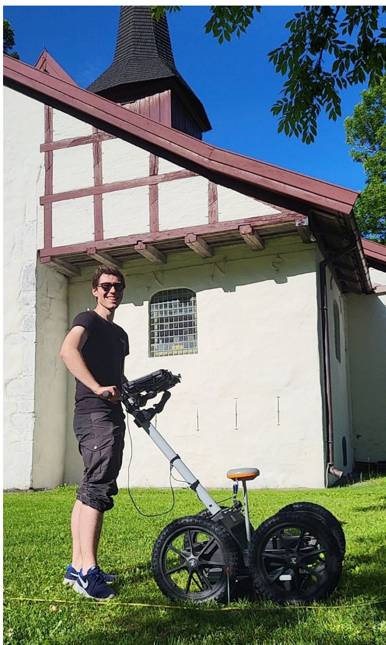
Figur 6: Jani Causevic med enkeltkanals georadar MIRA GX450 ved Tanum kirke. Foto: MK/NIKU.
