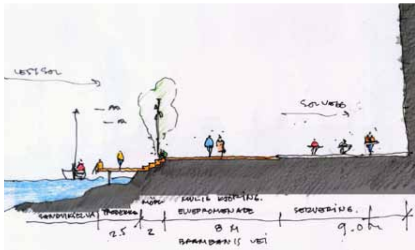
Tverrsnitt av elvepromenaden uten kjøring, Bjørnbekk & Lindheim
